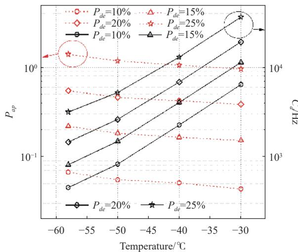
图7 总后脉冲概率和暗计数率在不同探测效率下随温度的变化
