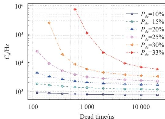
图5 暗计数率在不同探测效率下随死时间的变化
