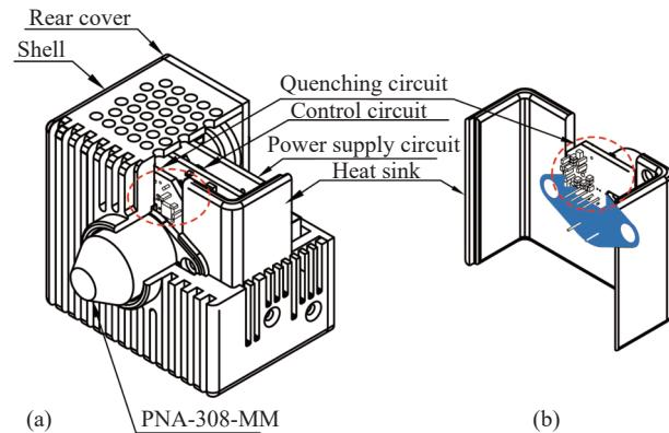
图2 基于InGaAs NFAD的集成型低噪声近红外单光子探测器设计图。(a)探测器剖视图;(b)探测器散热结构(红色虚线圈内为淬灭电路板及贴抗干扰屏蔽材料位置,蓝色区域为NFAD管壳与散热结构接触面)
