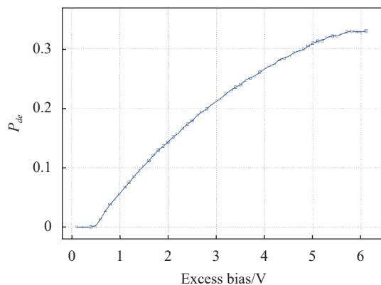
图4 探测效率随过偏压的变化
