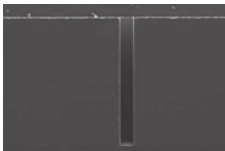
(c) 线宽 30\ \mu\text{m} 、深度 300\ \mu\text{m} 的样板
