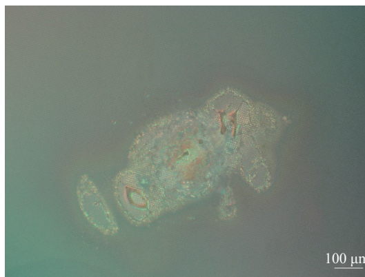
图 10 传感器的损伤形貌 ( 203.71 \text{ J/cm}^2 , 10 Hz)
