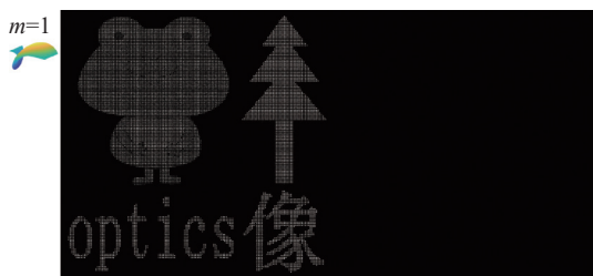
图 8 当 m = 1 的 OAM 光束照射时的解密结果
