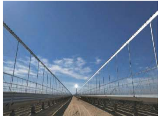
图 10 线性菲涅耳集热实验系统
