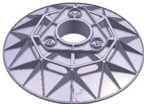
图 3 反射镜背部轻量化结构
